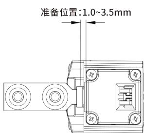
4.操作钥匙的安装允许误差在操作钥匙插入孔中心为基准 $\pm 1\text{mm}$ 范围内。
